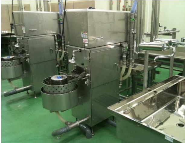
ぬめり残し洗浄部 ・内壁面ブラシ洗い ・搬送
